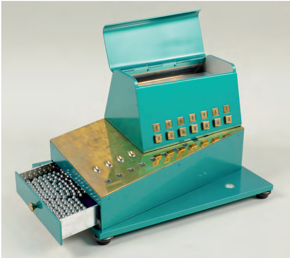
Abbildung 4. Duale Rechenvorrichtung nach Gottfried Wilhelm Leibniz (Nachbildung gebaut von Rudolf von Mackensen, 1972)
